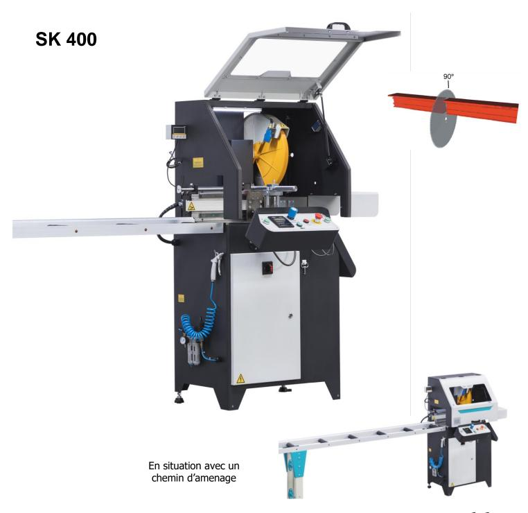
Permettant des **coupes droites uniquement à - 90°** de profilés ALU. Conçue pour l'utilisation de fraises-scies **Ø 400 mm**.
